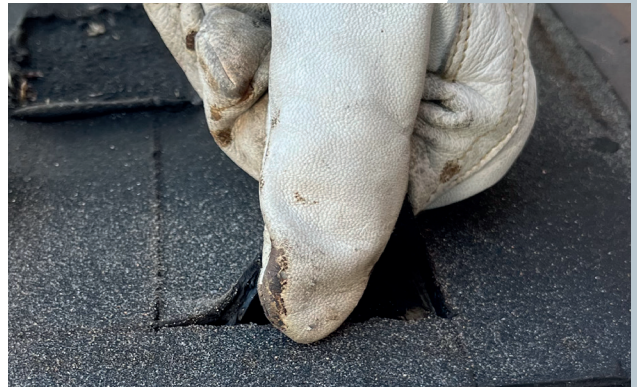
Remsan dras vinkelrät ut från underlaget.
